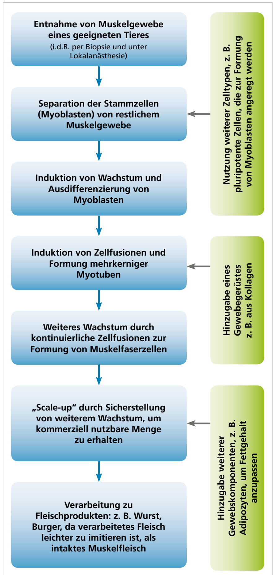
► Abb. 3: Vereinfachte Darstellung einiger der typischen Schritte zur Produktion von In-vitro-Fleisch (modifiziert nach [28])
